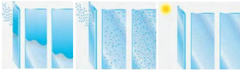
تصاویر ۲۲ و ۲۳ و ۲۴- شیشه خود تمیز شونده با خاصیت فتوکاتالیک و خاصیت هیدروفیلیک (Ritter, 2007)
