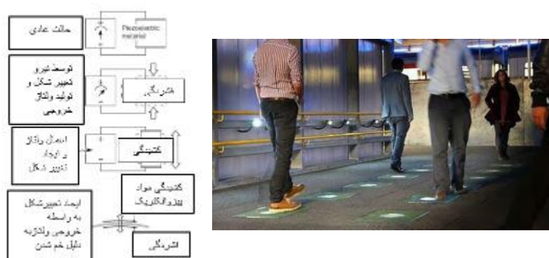
تصاویر ۳۴ و ۳۵- کاربرد تکنولوژی پیزوالکتريک در ایستگاه متروی توکیو و عملکرد پیزوالکتريک (Addington & Schodek, 2005)
