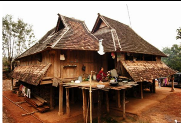
تصویر ۱۰- نمونه ای از خانه های بامبویی قوم دی، چین. خانه بر روی ستونهایی قرار گرفته و از فضای زیرین به عنوان انبار و طویله استفاده می شود. (مأخذ: wikipedia 2013)
