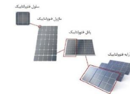
تصویر ۱۴- اجزا آرایه سیستم فتوولتاییک (جورسرایی آلاشتی، ۱۳۹۷)
