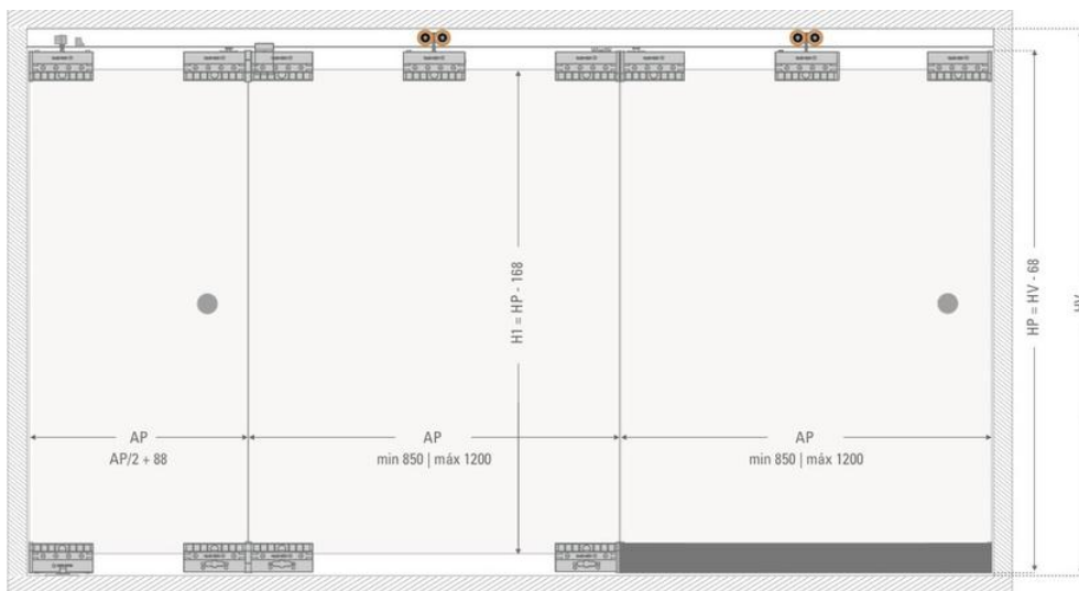
تصویر ۱۴. نمونه ای از چیدمان پانل های دیوار متحرک در نما (نگارندگان)
