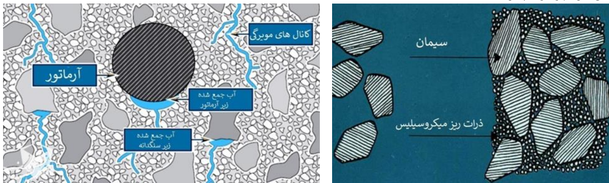
شکل ۲- کارکرد میکروسیلیس در عملکرد و دوام بتن. منبع: https://salmanco.com
