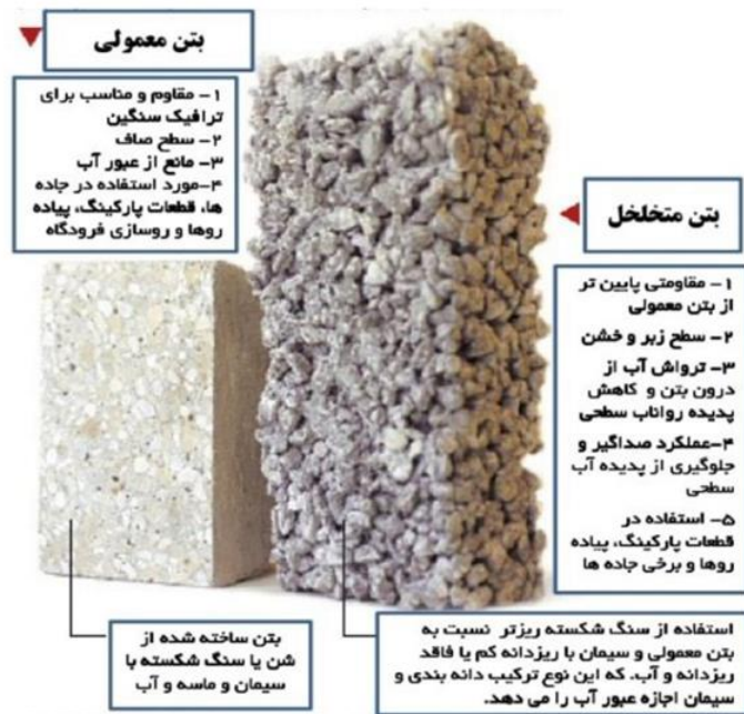
شکل ۴- مقایسه بتن معمولی در مقابل بتن متخلخل (منبع: شیرگر و همکاران، ۱۳۹۴)
