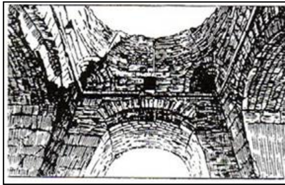
شکل ۳. شیوه پوشش چهارطاقی نیاسر با کمک تویزه گچی (گذار، ۱۳۷۱: ۳۱).
