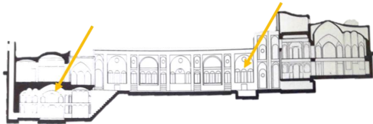
شکل ۳. مقطع طولی خانه طباطبایی‌ها (حاجی‌قاسمی، ۱۳۷۵)
