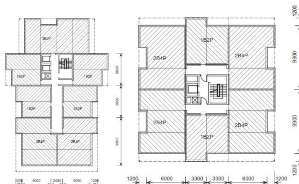
شکل ۸- فرم های رایج ساختمان های بلند مرتبه با استفاده از مدول ها و هسته های بتونی، (ماخذ: Lawson &amp; Richards 2010)
