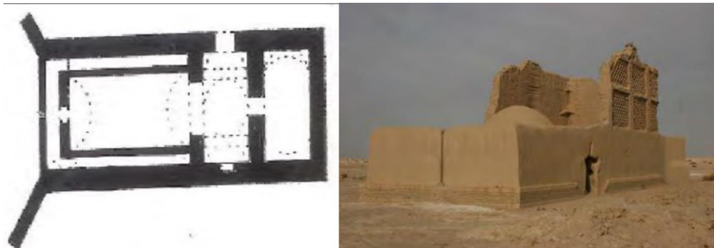
شکل ۳ - نمونه آسباد منفرد همراه پلان در منطقه حوضدار سیستان و بلوچستان ( منبع:رستگارزاله و آزاد، ۱۳۹۴)
