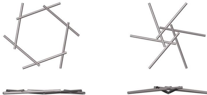
شکل 12: کاهش اندازه چشمه داخلی موجب افزایش ارتفاع کلی سازه می‌شود (نگارندگان).
