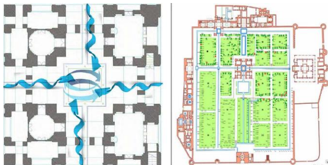
شکل ۴- راست: پلان باغ فین؛ چپ: سامانه تهویه طبیعی در کوشک باغ فین (نعیما، ۱۳۸۵: ۴۸)
